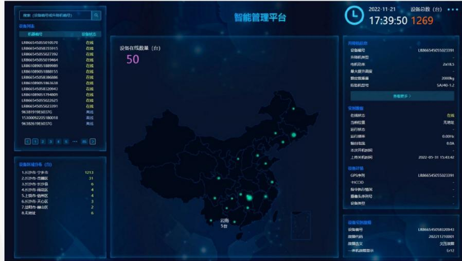
设备运维平台：用户可通过App以及PC客户端获取机械设备的运行状态、限位状态、故障状态等数据，远程进行升降机限速、升降锁机、超载清零和故障复位等操作，实现施工升降机的精准定位以及笼内视频的实时监控。
